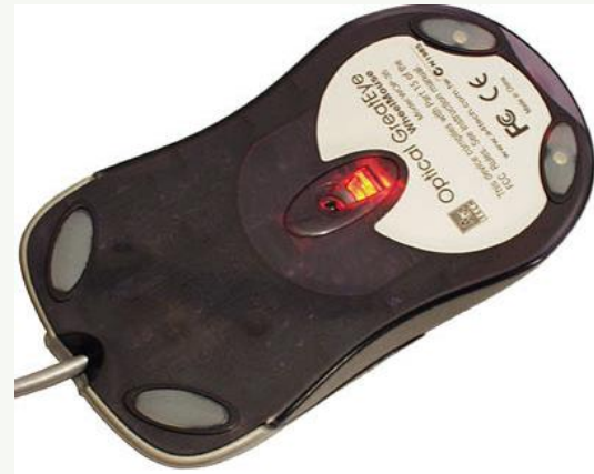
Оптические мыши (светодиодные и лазерные)
